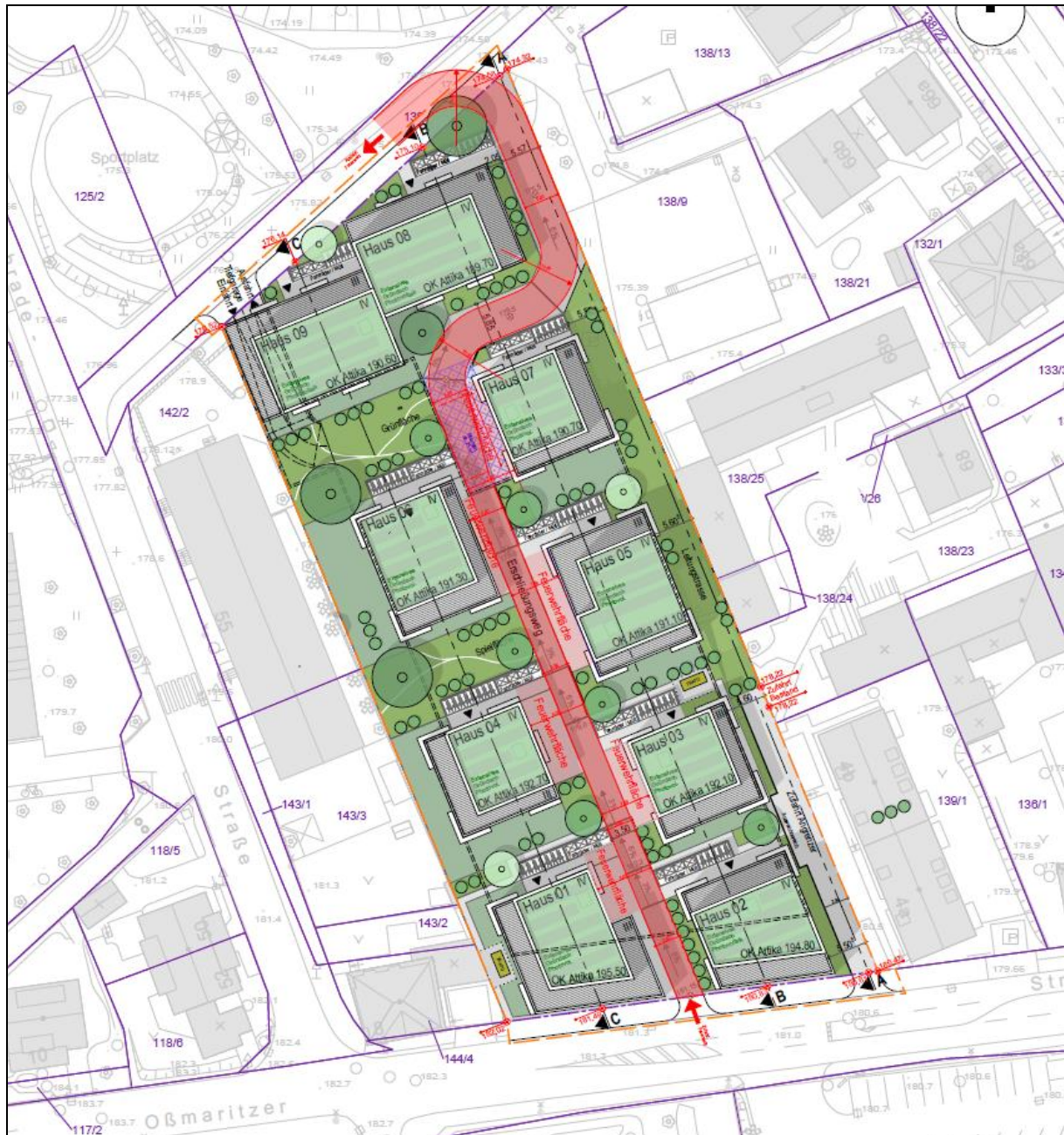
Abb.: 2 Lageplan mit Feuerwehrezufahrt, Schleppkurven und Aufstellflächen (Quelle: Bramey und Partner, Vorhaben- und Erschließungsplan, Stand 09.11.2023)
