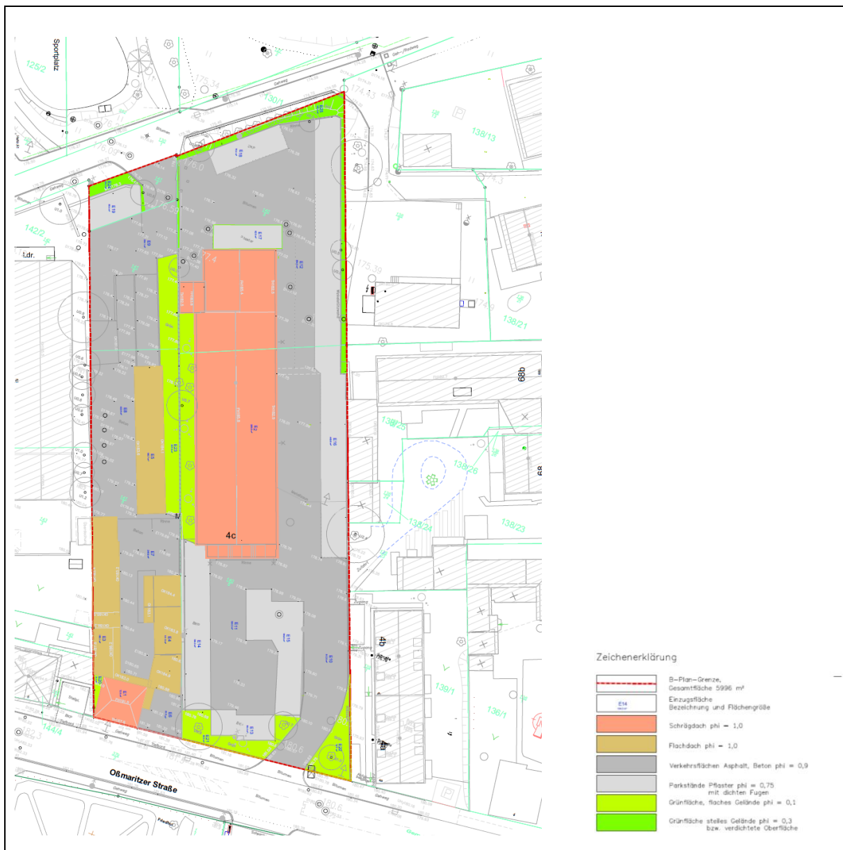
Abb. 7: Bodenversiegelung und - verdichtung (Bestand)
