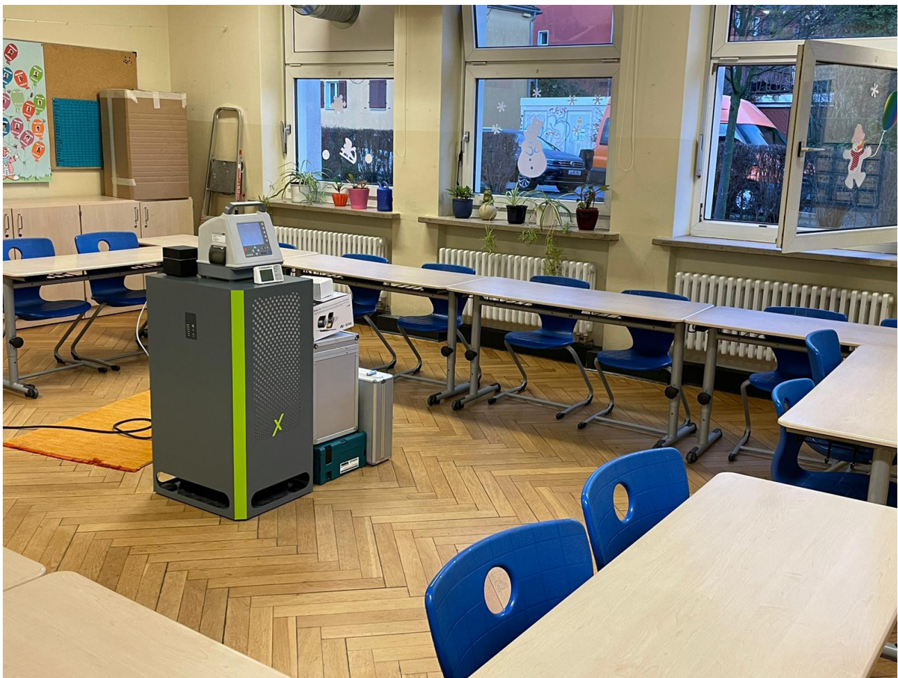
Abbildung 7: Südschule | Raum 00_18 | Raumlufreiniger mit HEPA-14 Filter, Volumenstrom ca. 650 m 3 /h
