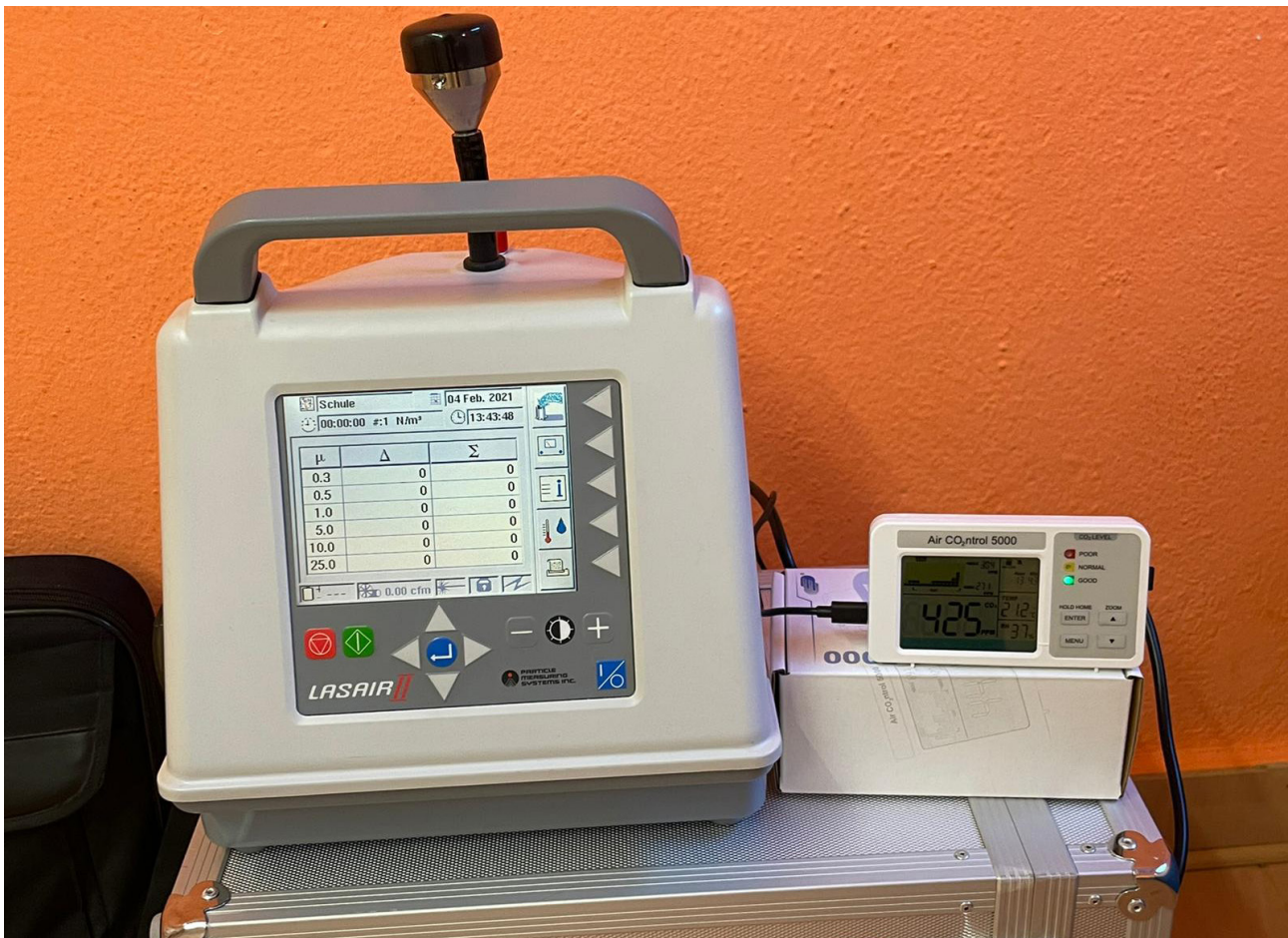
Abbildung 6: Kindertagesstätte Kindervilla | Raum Landgrafenberg | Messaufbau Fensterlüftung | Partikelmessgerät und CO 2 -Datenlogger
