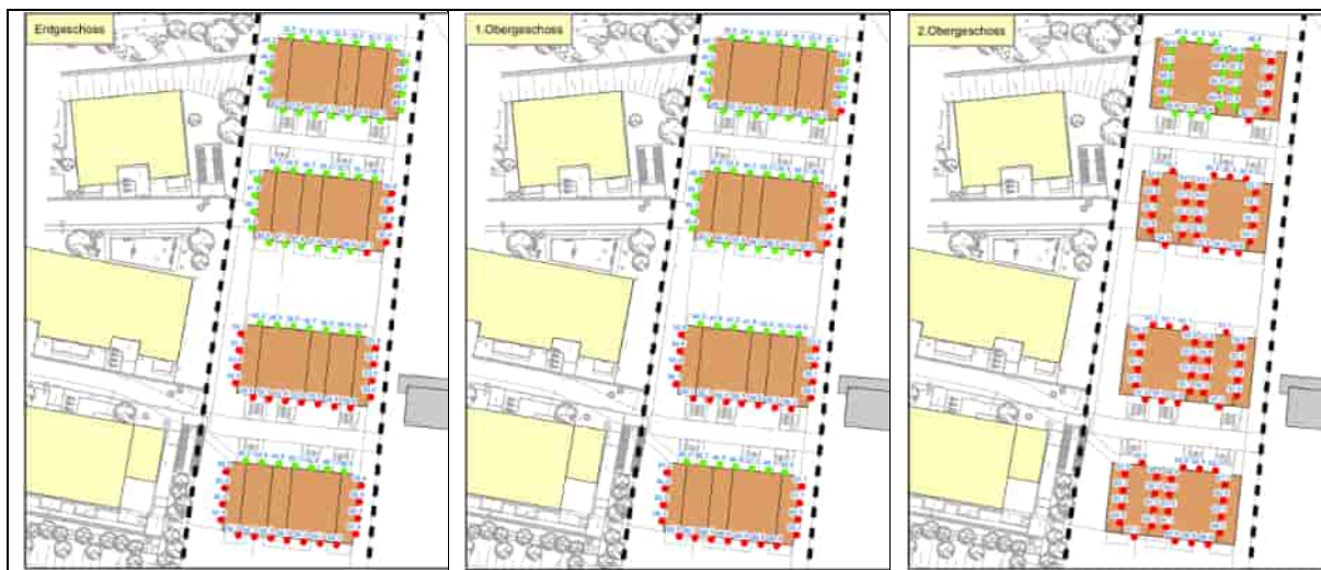
ABBILDUNG 7: Berechnungsergebnis Verkehrslärm tags an den Fassadenabschnitten; Vergleich mit dem Orientierungswert für ein WR-Gebiet ( unterschritten | überschritten )
