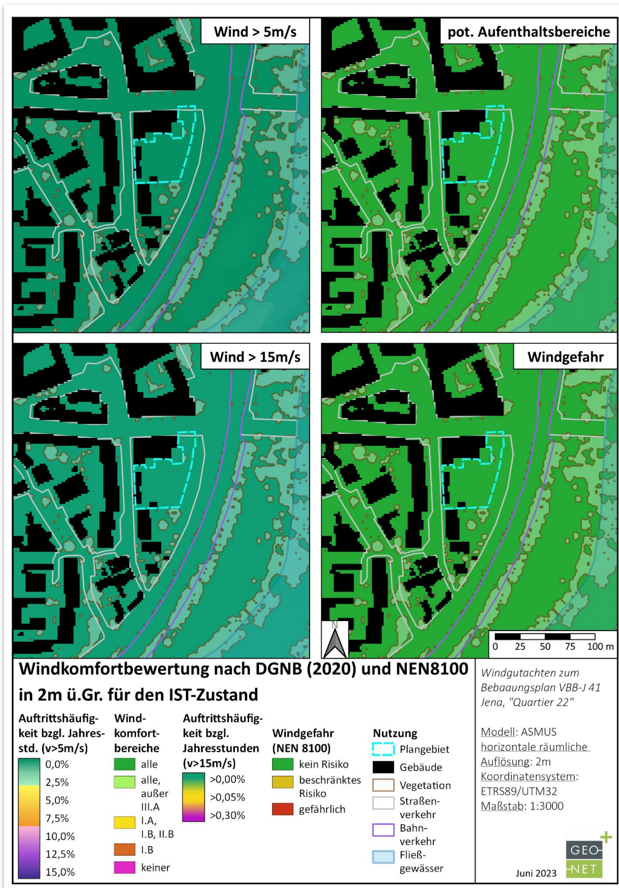
Abb. 3.4: Kartenausschnitt zum Windkomfort für den Istzustand in 2m Höhe nach den vorgegebenen Kriterien des DGNB (2020) und der NEN 8100 zu Überschreitungshäufigkeiten einer jeweiligen mittleren Windgeschwindigkeit >5\text{m/s} (oben links) bzw. >15\text{m/s} (unten links) bzgl. der Jahresstunden und den daraus abgeleiteten potentiellen Windkomfortbereichen (oben rechts) bzw. möglichen Windgefahren (unten rechts).
