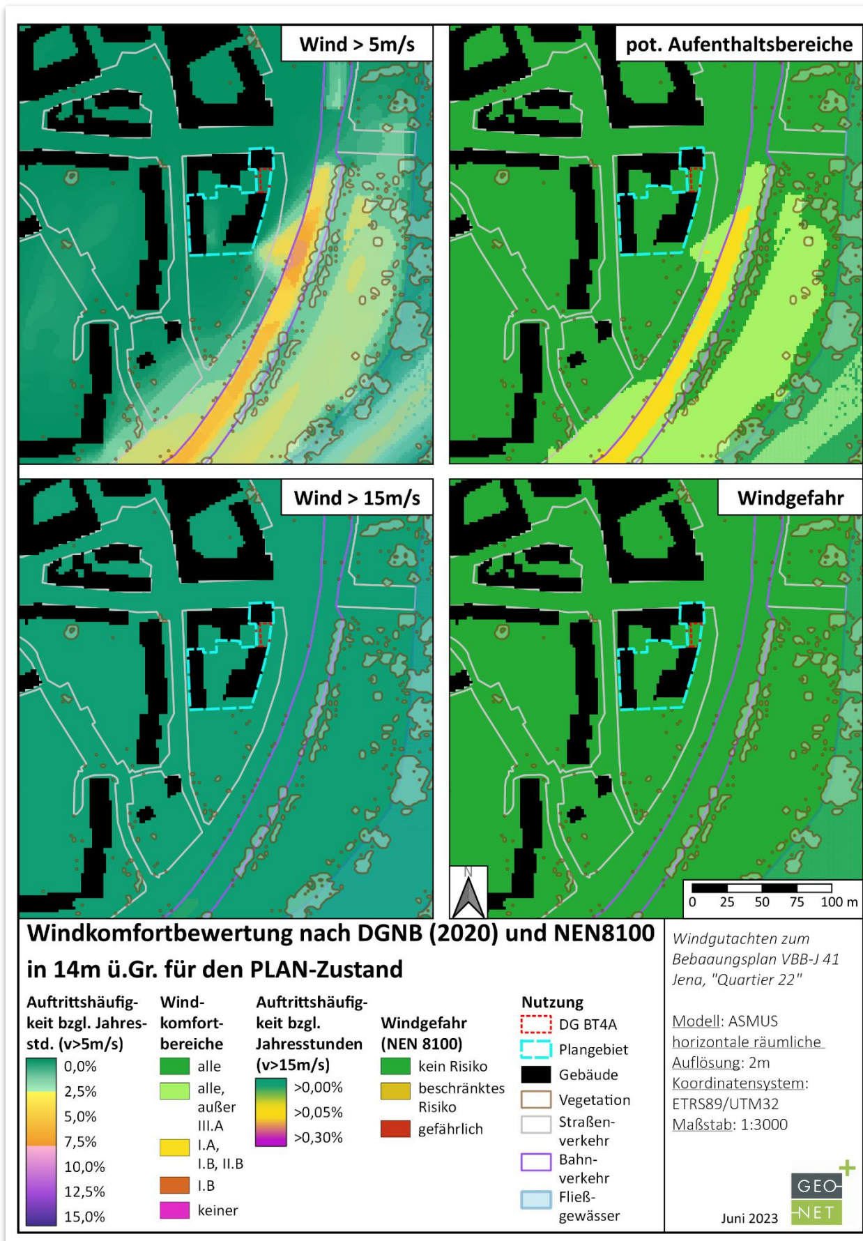
Abb. 3.7: Kartenausschnitt zum Windkomfort für den Planzustand in 14m Höhe (DG BT 4A) nach den vorgegebenen Kriterien DGNB (2020) und der NEN 8100 zu Überschreitungshäufigkeiten einer jeweiligen mittleren Windgeschwindigkeit > 5\text{m/s} (oben links) bzw. > 15\text{m/s} (unten links) bzgl. der Jahresstunden und den daraus abgeleiteten potentiellen Windkomfortbereichen (oben rechts) bzw. möglichen Windgefahren (unten rechts).
