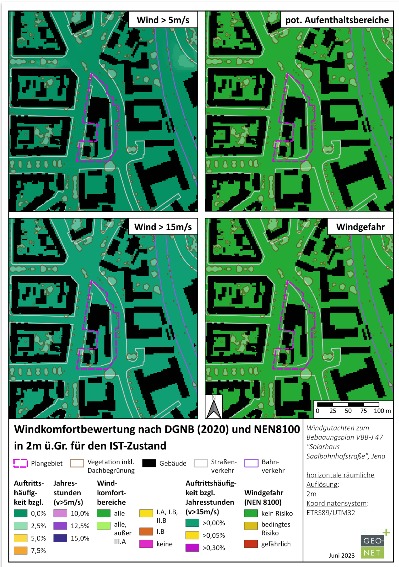
Abb. 3.2: Bewertung des Windkomforts für den Istzustand auf Grundlage der Kriterien des DGNB (2020) und der NEN 8100 zu Überschreitungshäufigkeiten einer jeweiligen mittl. Windgeschwindigkeit >5m/s bzw. >15m/s bzgl. der Jahresstunden und der daraus abgeleiteten potentiellen Windkomfortbereiche bzw. möglichen Windgefahr.
