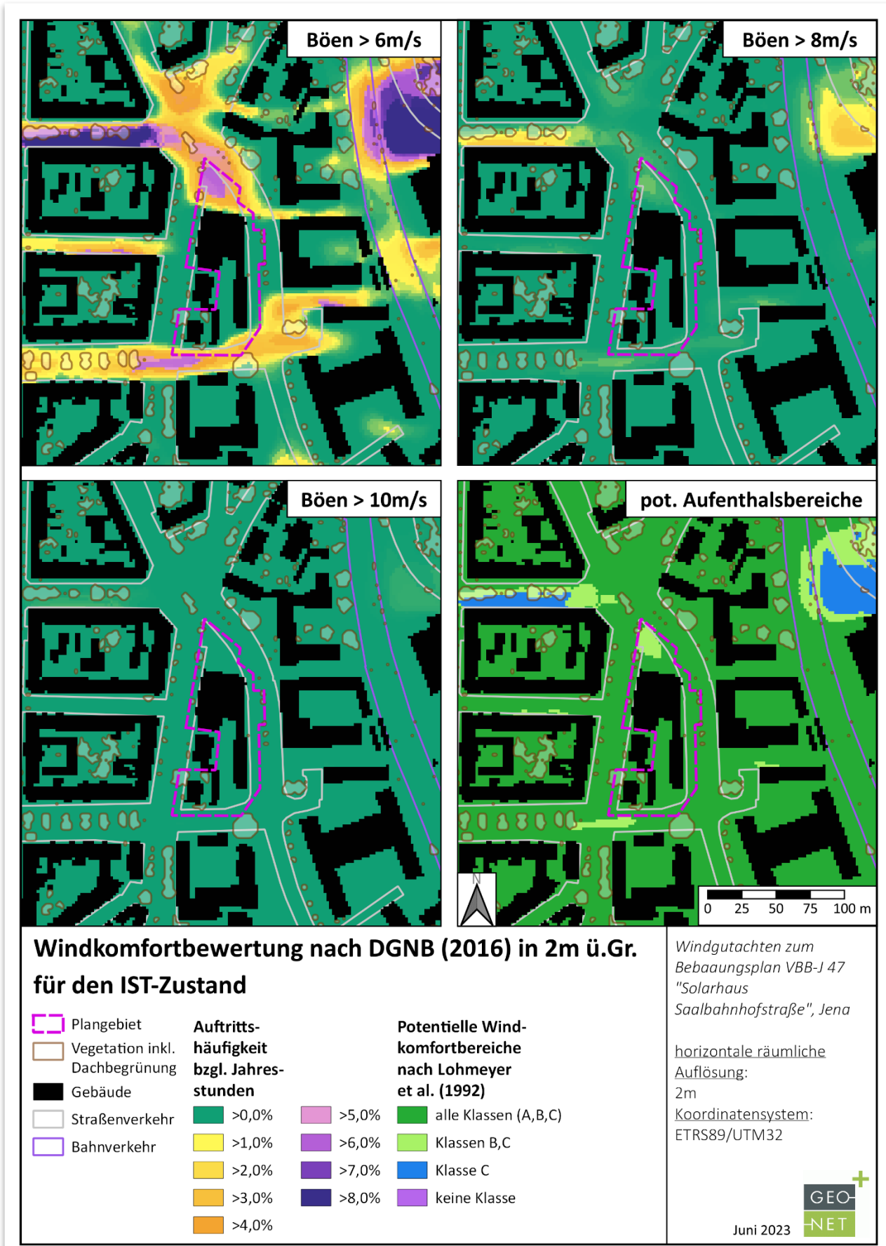
Abb. 3.9: Bewertung des Windkomforts für den Istzustand in 2m Höhe auf Grundlage der Kriterien des DGNB (2016) zu Überschreitungshäufigkeiten für festgelegten Böengeschwindigkeiten (6 / 8 / 10 m/s) bzgl. der Jahresstunden und den sich daraus ableitenden potentiellen Windkomfortbereich.
