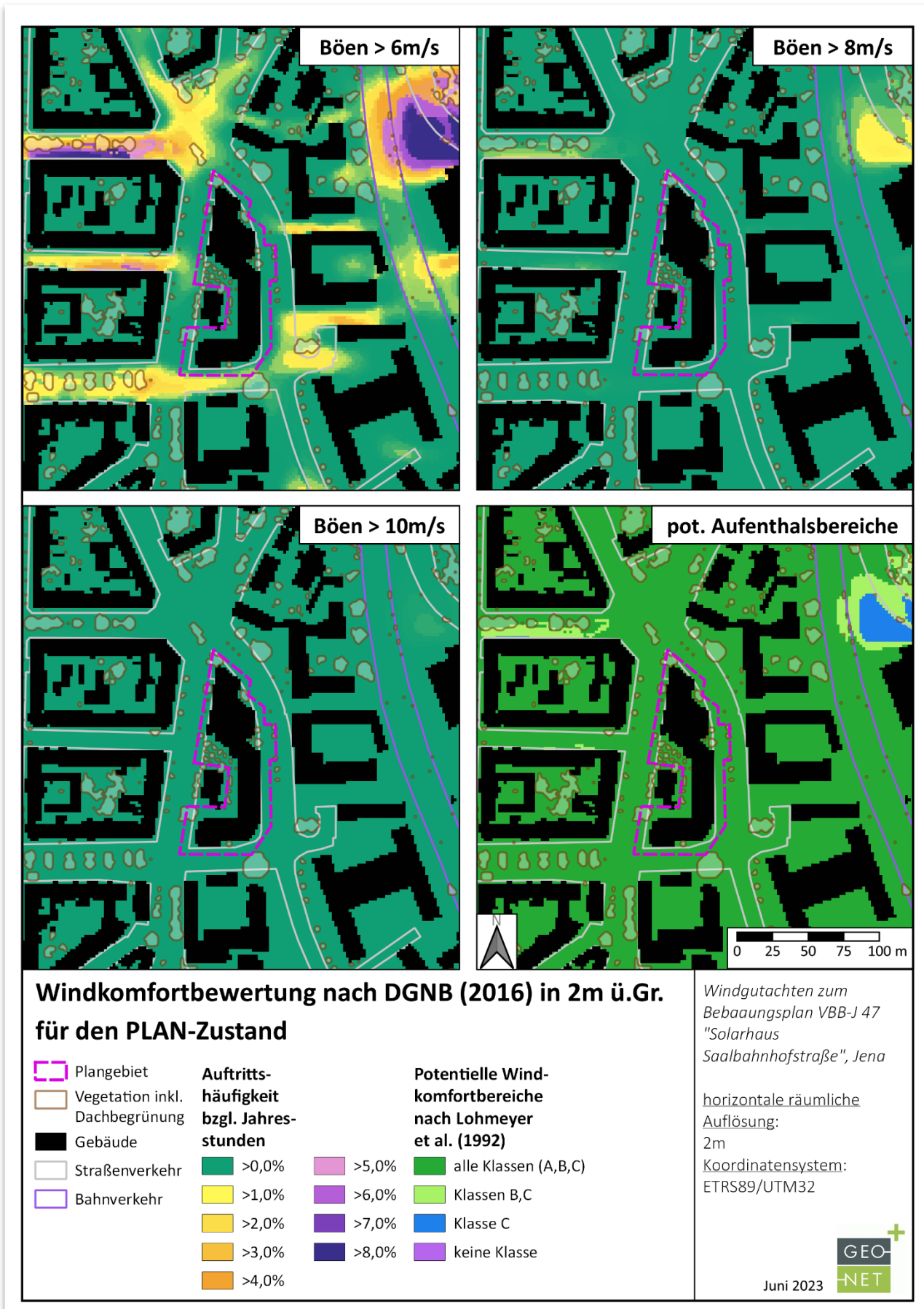
Abb. 3.10: Bewertung des Windkomforts für den Planzustand in 2m Höhe auf Grundlage der Kriterien des DGNB (2016) zu Überschreitungshäufigkeiten für festgelegte Böengeschwindigkeiten (6 / 8 / 10 m/s) bzgl. der Jahresstunden und den sich daraus ableitenden potentiellen Windkomfortbereich.
