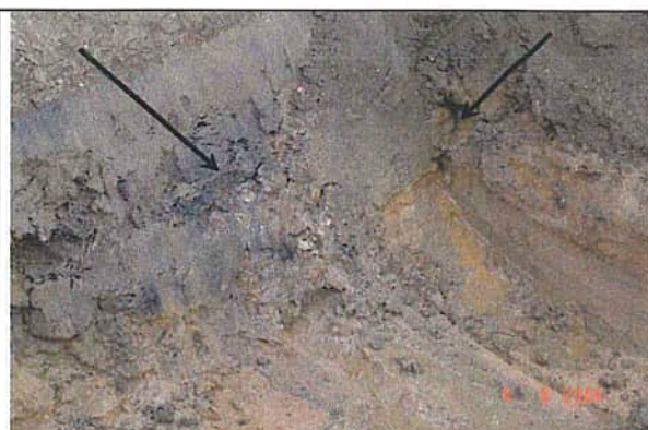
Wasserzutritt (schwarz gefärbt) aus Kieslinsen
