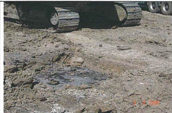
Probeschurf Ostteil Deckschichtstärke 40 cm
